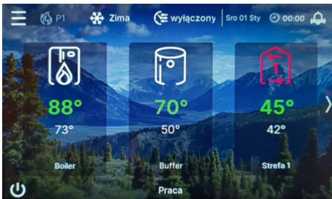
Rysunek 2. Widok ekranu głównego dla układu z buforem (P26=2-3)
